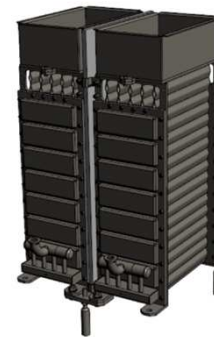
Echangeur-réacteur d'un système à absorption eau/LiBr (crédits CEA)
